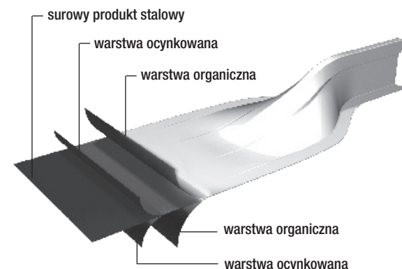
Rys. 5: Przekrój warstw profili T
